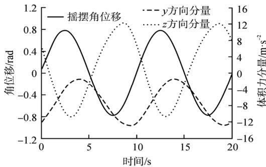
图1 横摇相关量以及质量力变化曲线
