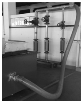
图 6 风阀内、外泄漏试验装置
