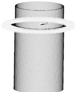
图 2 吊篮组件的有限元模型
