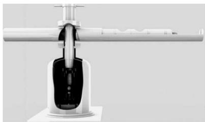
图 2 高温气冷堆球形燃料元件模拟事故加热装置
