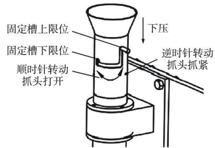
图7 抓头张开与抓紧时推杆操作示意图
